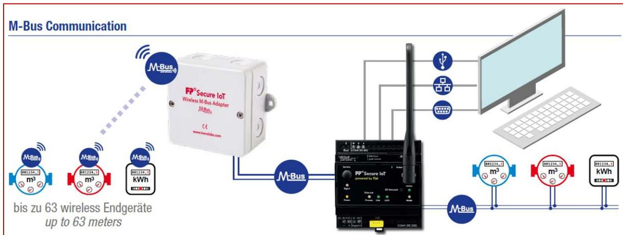
**Bild 2: Wireless M-Bus System mit wMBus Adapter und FP S-ENGuard IoT Gateway**
